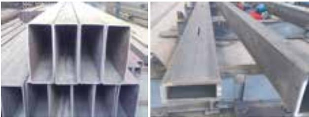
图5 宽钢管混凝土柱
