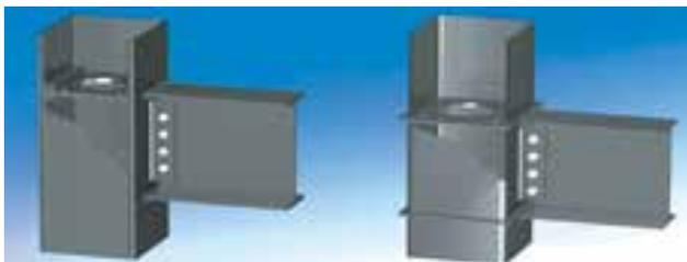
图6 传统钢管混凝土柱和H型钢梁的隔板连接节点
