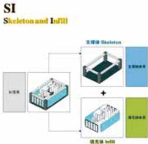
图：SI 建筑体系示意图
