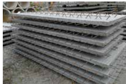
图一 叠合板底板出筋
