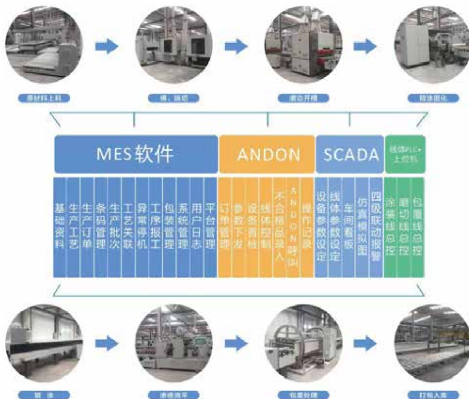
⑤ 装配式装修智造生产线
